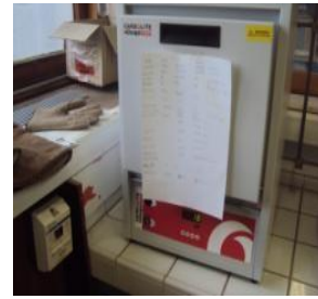
Photo -2 : Four Carbolite pour le traitement à haute température
